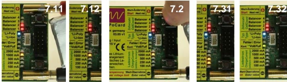
**-7.1-** Stecken Sie den Akku an das integrierte Ladekabel an. Zellenzahl und Akkutyp kontrollieren. Wenn keine Falschpolung und keine falsche Zellenzahl erkannt wird blinkt die Akkutyp-LED/Li-Fe: LEDs (=„Bereit“).
